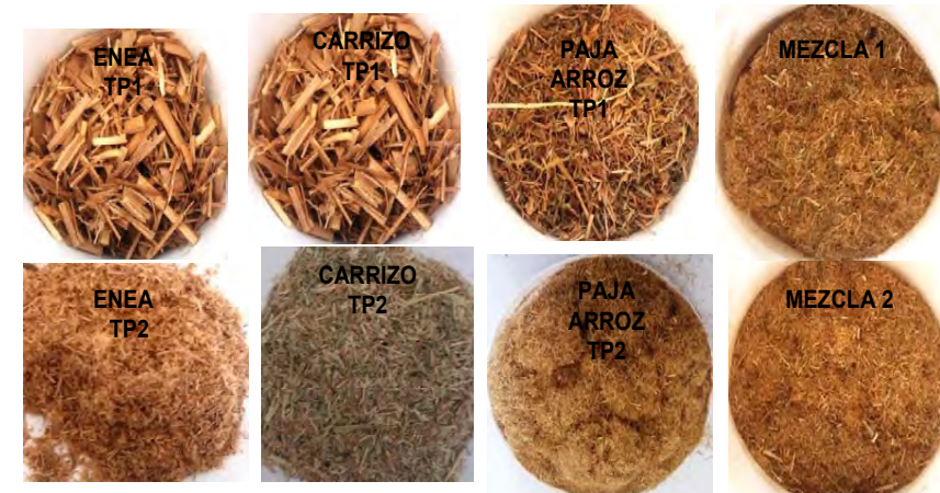
Figura 1. Ilustración de los sustratos analizados en el estudio de biometanización (TP1: tamaño de partícula medio 1; TP2: Tamaño de partícula medio 2).
