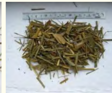
Figura 16 De izquierda a derecha: triturado sencillo de carrizo, triturado doble de carrizo, triturado de precisión de carrizo [REF 3].
