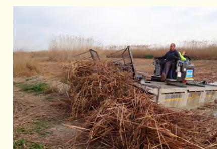
Figura 11. Derecha Truxor equipada con el apero rastrillo recogiendo la biomasa segada.
