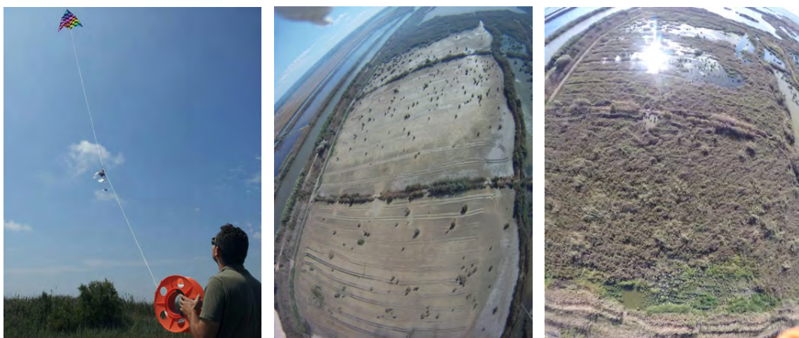
Figura 24 Vuelo de cometa con cámara GoPro e imagen aérea antes y después de la plantación en el HATP.
