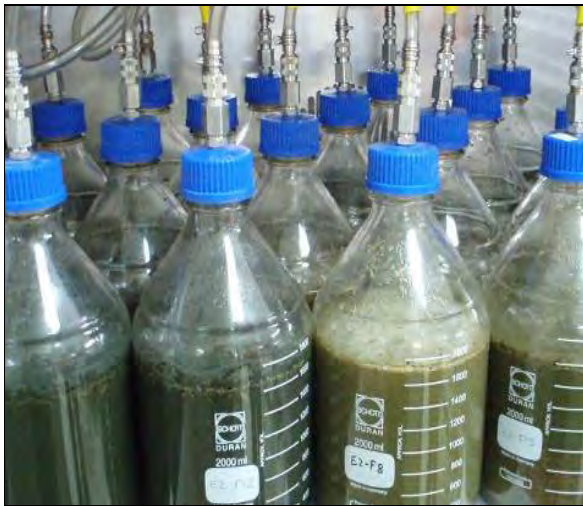
Figura 2. Montaje experimental de los ensayos batch de biodegradación anaerobia
