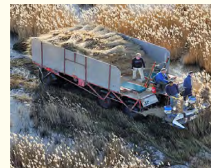
Figura 42 Máquina cosechadora de carrizo [31].
