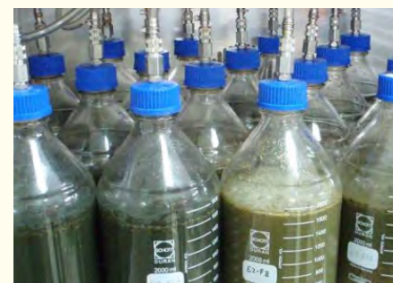
Figura 26 Montaje experimental en laboratorio de los ensayos batch de biodegradación anaerobia.
