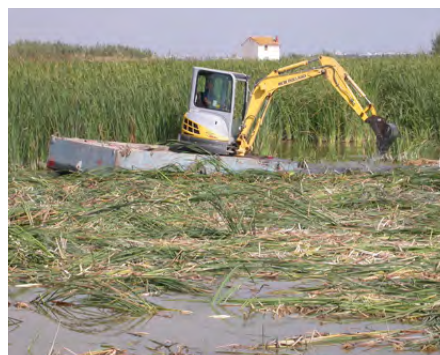
Figura 30 Cosecha con excavadora flotante y retirada de la biomasa con pulpo (HATM).
