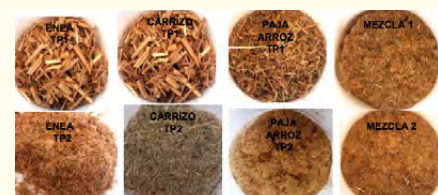
Figura 25 Ilustración de los sustratos analizados en el estudio de biometanización [TP1: tamaño de partícula medio 1 (1-5cm); TP2: Tamaño de partícula medio 2 (0,5-1,5cm)].
