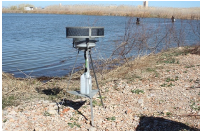
Figura 50 Imagen de captador atmosférico colocado en HATLI.
