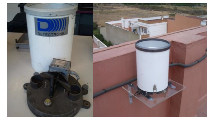
Figura 46 Pluviógrafo de balancín e instalación en la azotea de un edificio.
