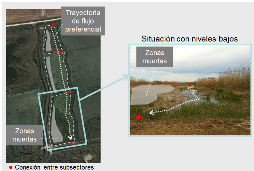
Figura 34 Ilustración del desarrollo de zonas de flujo preferentes y zonas muertas en el sector B del HATP.
