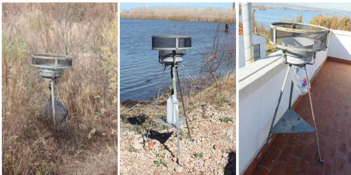
Figura 3. Captadores atmosféricos utilizados en el HATP, HATLI y HATM, respectivamente.
