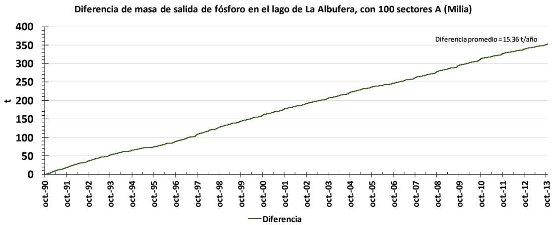
Gráfica 3-187. Diferencia de masa de fósforo de salida en el lago de la Albufera, depurando agua del lago. (100 sectores A tancat Milia).
