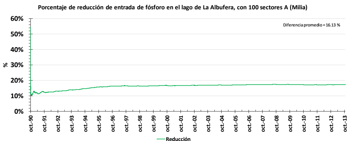
Gráfica 3-185. Porcentaje de reducción entre las concentraciones de fósforo de entrada en el lago de la Albufera, depurando agua del lago. (100 sectores A tancat Milia).
