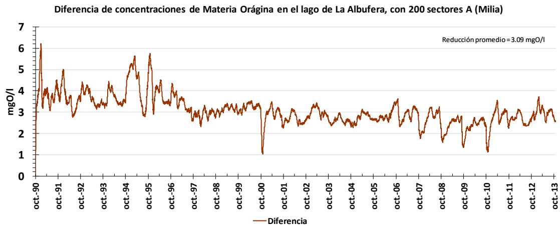
Gráfica 3-217. Diferencia de concentraciones de materia orgánica en el lago de la Albufera, depurando agua del lago. (200 sectores A tancat Milia).
