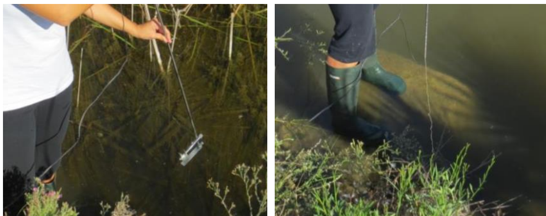
Figura 5.5. Aforo con minimolinete de uno de los tubos de conexión entre celdas
